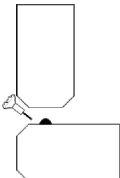
Lepidlo musí být před sesazením naneseno v rovnoměrné vrstvě, výhodné je opět použití přísavek
