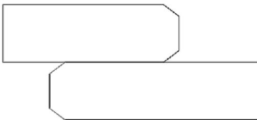
Používá se v případě, kdy by tupý spoj byl příliš zatížen působením pákové síly (přesah 2x tloušťka skla)
